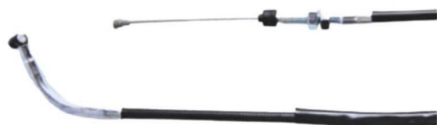
MMCB007 CABO EMBREAGEM - MMCB007 - MIDE PARTS HONDA: CG TITAN 150 KS / ES / ESD / MIX (2009-2010)
